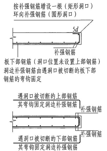
**洞边被切断钢筋端部构造**
