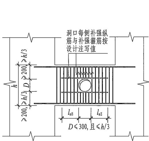
连梁中部圆形洞口补强钢筋构造
