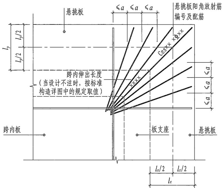
图7.2.10-3 悬挑板阳角放射筋Ces引注图示(三)
