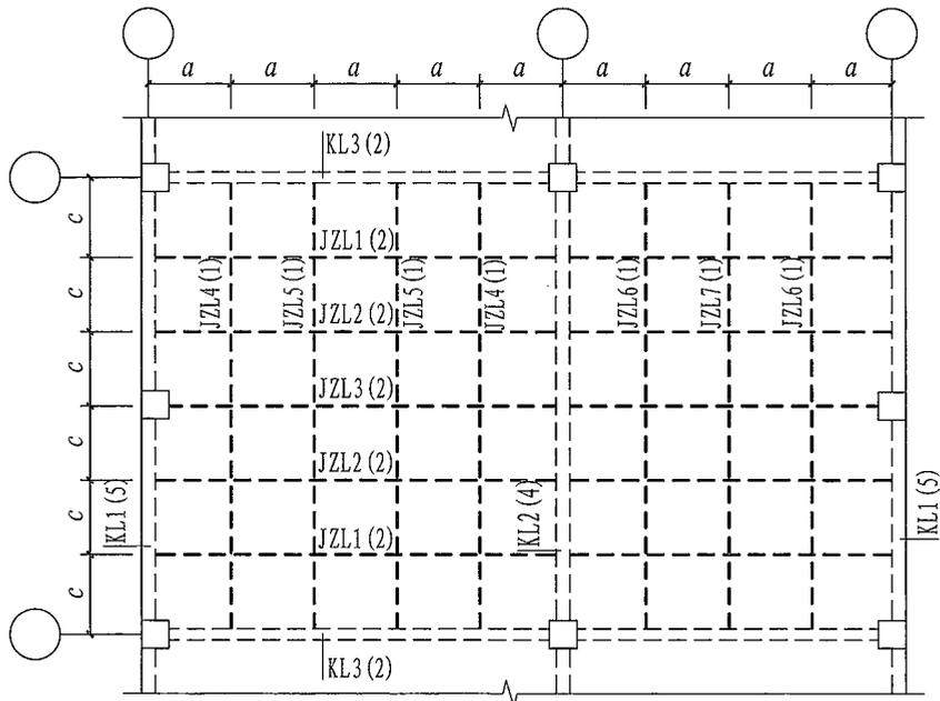
图4.2.7 井字梁矩形平面网格区域示意
