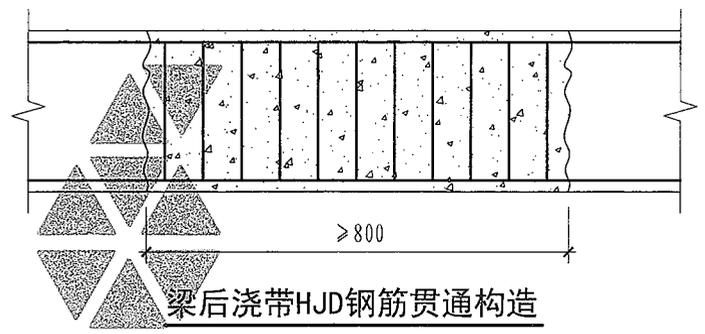
梁后浇带HJD钢筋贯通构造
