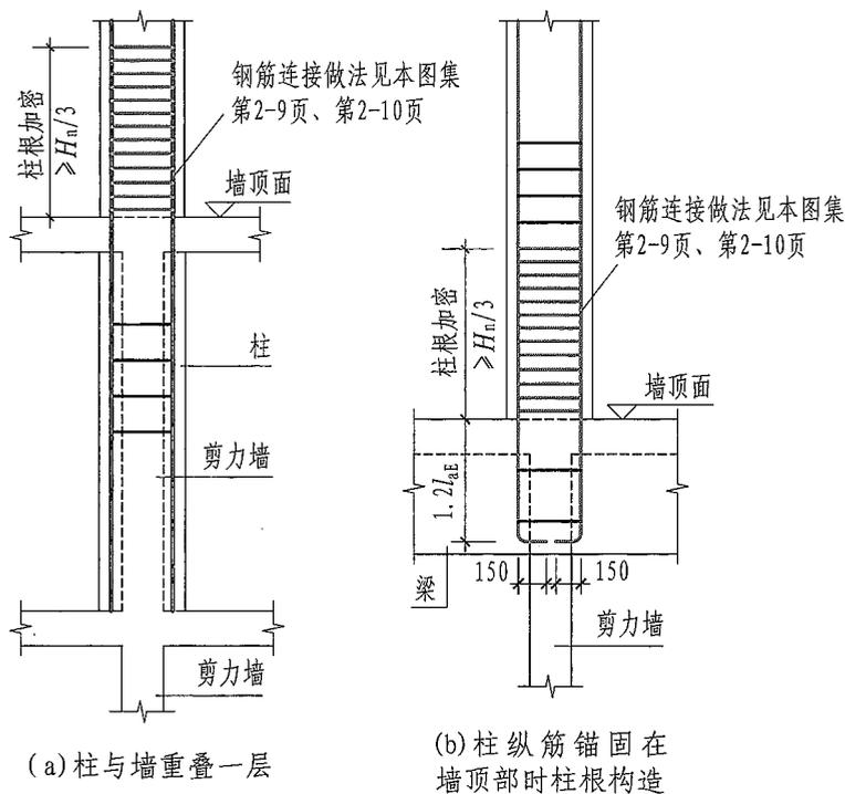
**剪力墙上起柱KZ纵筋构造**
