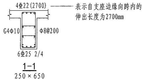
图4.2.8-2 井字梁截面注写方式示例
