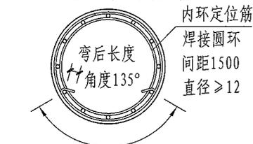
搭接 $\geq l_a$ 或 $l_{aE}$ , 且 $\geq 300$ 勾住纵筋
