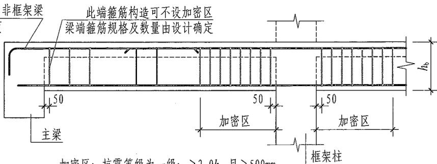
加密区: 抗震等级为一级:  $\geq 2.0h_b$ , 且  $\geq 500\text{mm}$
