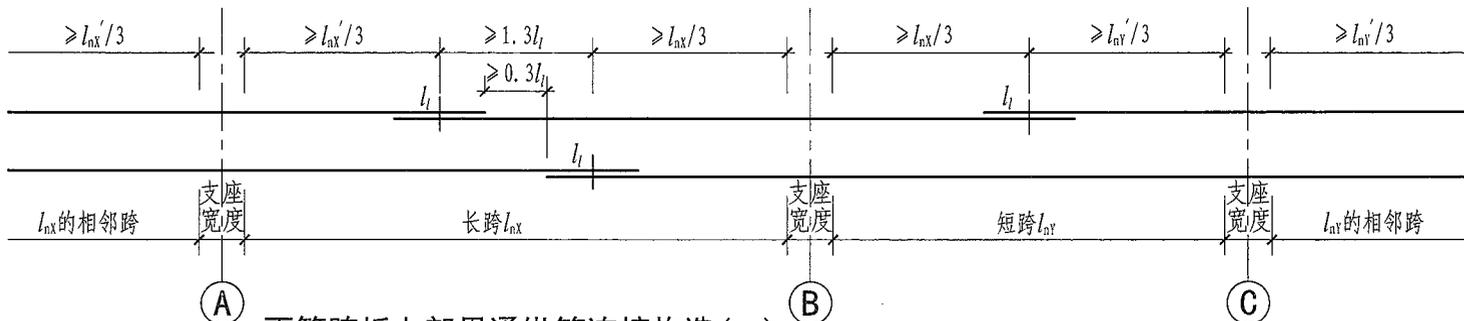
**(A) 不等跨板上部贯通纵筋连接构造(二) (B) (C)**
