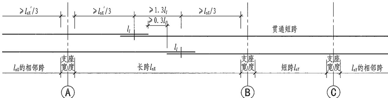
**(A) 不等跨板上部贯通纵筋连接构造(三) (B) (C)**
