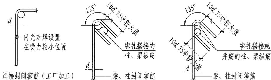
焊接封闭箍筋(工厂加工)
