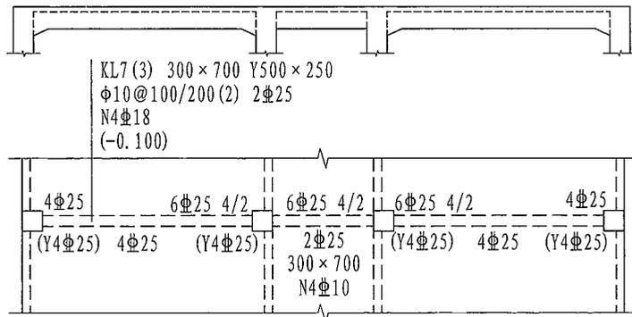
图4.2.4-2 梁竖向加腋平面注写方式表达示例
