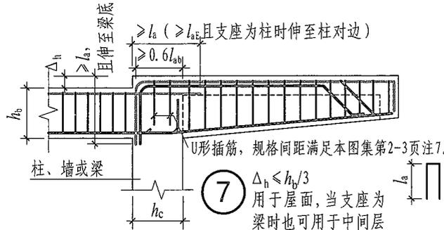
注: 1. 括号内数值为框架梁纵筋锚固长度。当悬挑梁考虑竖向地震作用时(由设计明确), 图中悬挑梁中钢筋锚固长度  $l_a$ 、 $l_{ab}$  应改为  $l_{aE}$ 、 $l_{abE}$ , 悬挑梁下部钢筋伸入支座长度需要时  $15d$  改为  $l_{aE}$  (由设计明确)。
