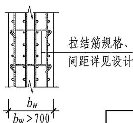
注: 1. 剪力墙分布钢筋配置若多于两排, 水平分布筋宜均匀放置, 竖向分布钢筋在保持相同配筋率条件下外排筋直径宜大于内排筋直径。
