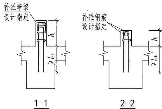
注: 1. 托柱转换梁的纵向钢筋配筋构造具体做法见本图集第2-47页。
