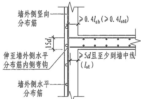
(括号内的数值用于梁板式转换层的板。当板下部纵筋直锚长度不足时,可弯锚,见图1)
