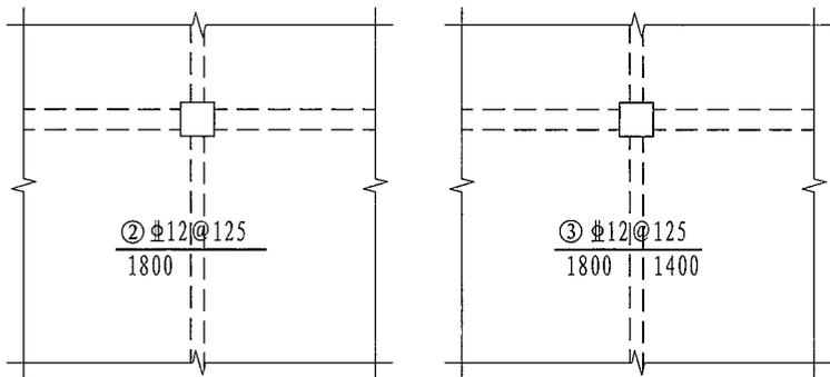
图5.3.1-1 板支座上部非贯通纵筋对称伸出
