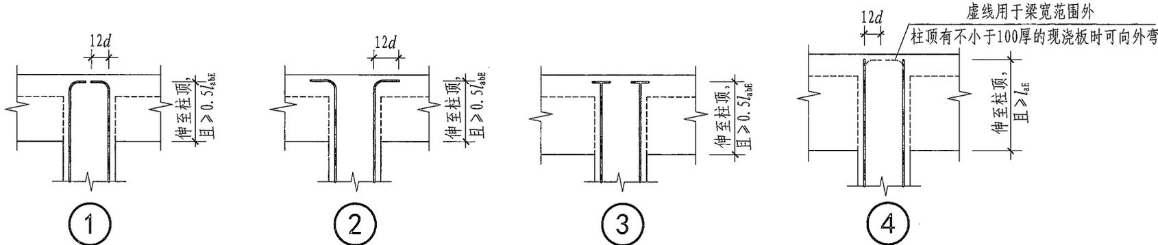
(当柱顶有不小于100厚的现浇板) 柱纵向钢筋端头加锚头(锚板) (当直锚长度  $\geq l_{aE}$  时)
