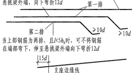
当悬挑梁根部与框架梁梁底齐平时, 底部相同直径的纵筋可拉通设置
