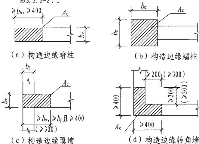
图3.2.2-1 构造边缘构件
