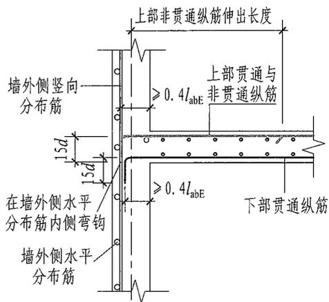
(c) 柱上板带与剪力墙中间层连接
