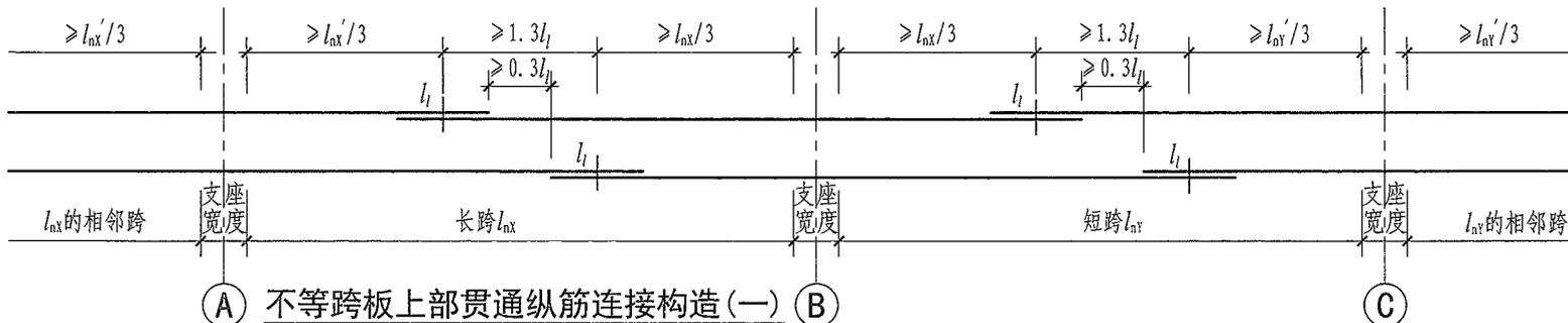
**(A) 不等跨板上部贯通纵筋连接构造(一) (B) (C)**
