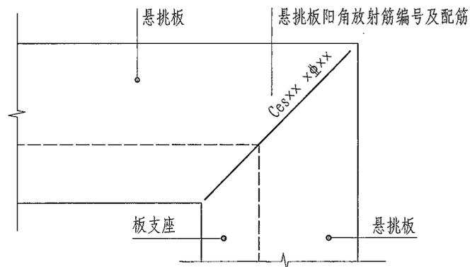
图7.2.10-2 悬挑板阳角放射筋Ces引注图示（二）
