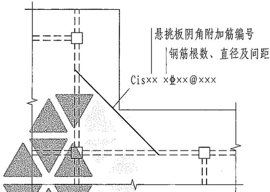
图7.2.9 悬挑板阴角附加筋Cis引注图示
