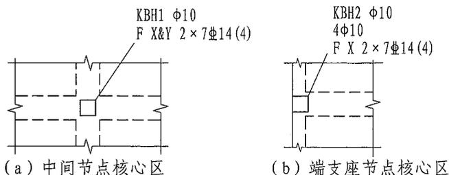
图4.2.6 框架扁梁节点核心区附加钢筋注写示意图
