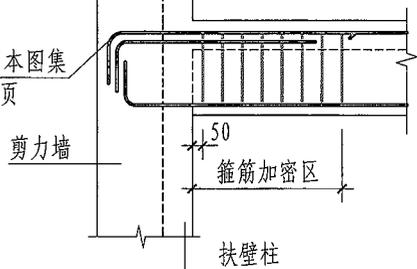
框架梁(KL、WKL)与剪力墙平面外构造(二)
