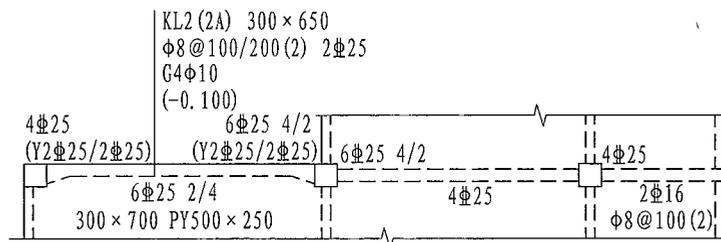
图4.2.4-3 梁水平加腋平面注写方式表达示例
