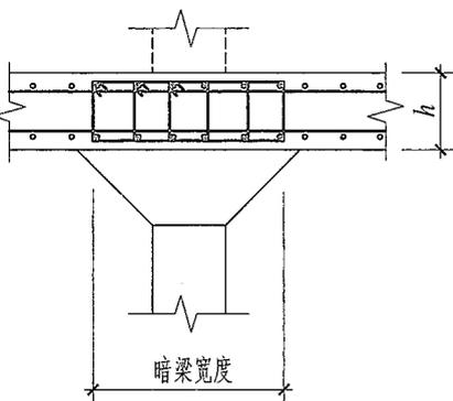
注：暗梁配筋详见设计，纵向钢筋构造同柱上板带钢筋。
