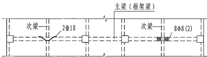
图4.2.4-4 附加箍筋和吊筋的画法示例
