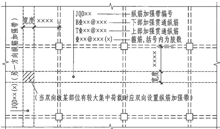
图7.2.1-2 纵筋加强带JQD引注图示（暗梁形式）
