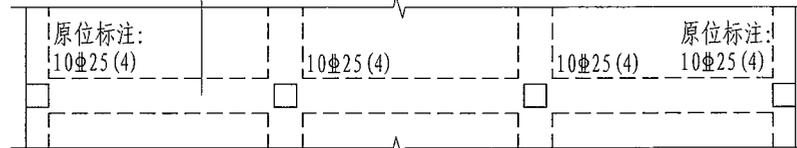
图4.2.5 框架扁梁平面注写方式示例
