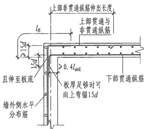
(d) 柱上板带与剪力墙顶层连接
