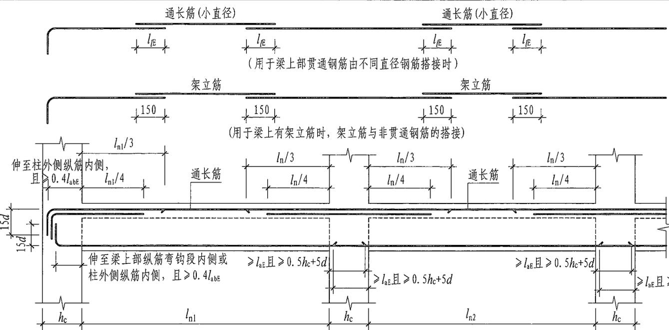
楼层框架梁KL纵向钢筋构造
