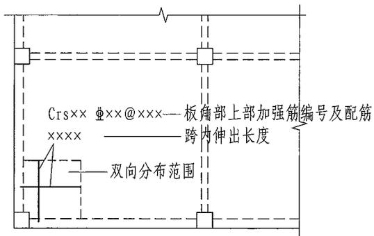
图7.2.8 角部加强筋Crs引注图示
