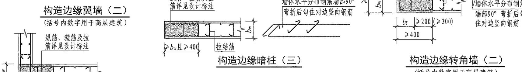
注: 1. 构造边缘构件 (二)、(三) 用于非底部加强部位, 当构造边缘构件内箍筋、拉筋位置 (标高) 与墙体水平分布筋相同时采用, 此构造做法应由设计者指定后使用。计入的墙水平分布钢筋不应大于边缘构件箍筋总体积 (含箍筋、拉筋以及符合构造要求的水平分布钢筋) 的50%。
